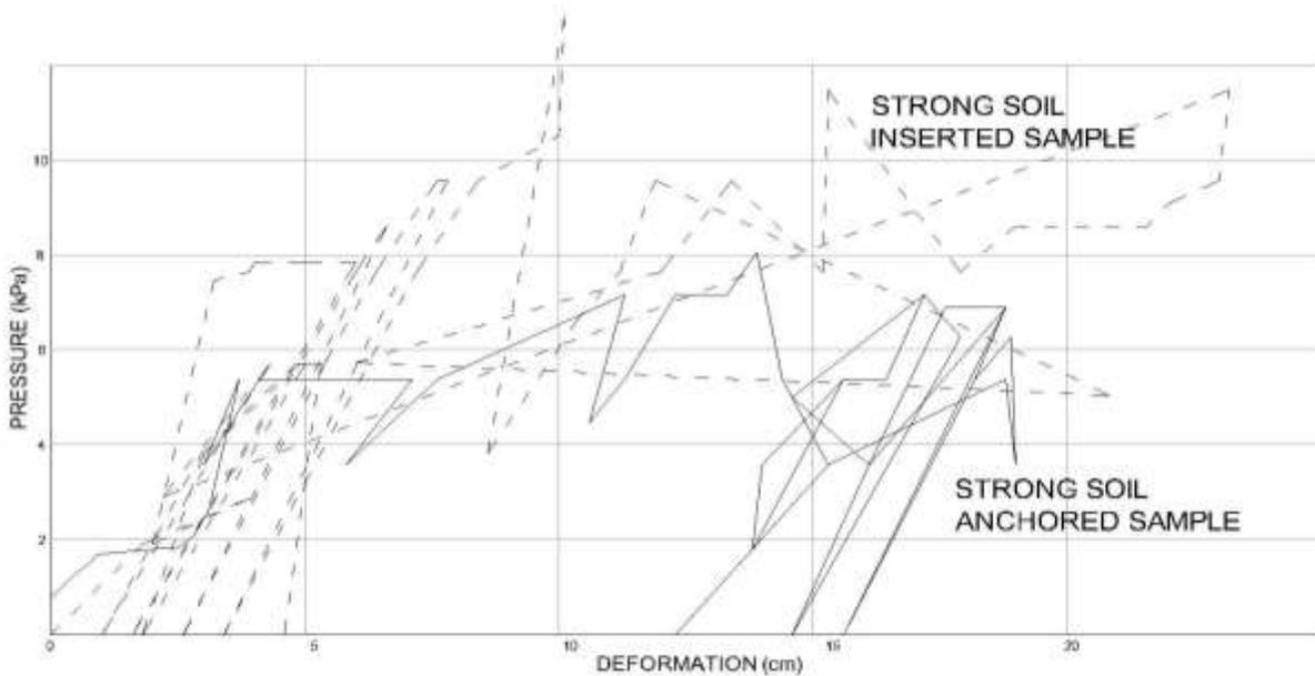
**CONTAINED EARTH SHEAR TEST RESULTS**
