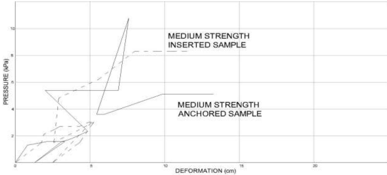
**CONTAINED EARTH SHEAR TEST RESULTS**
